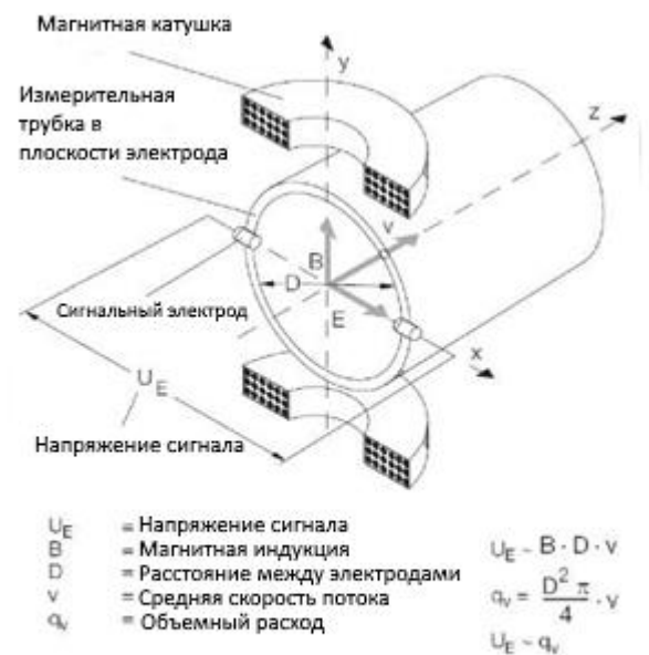
Схема электромагнитного расходомера
